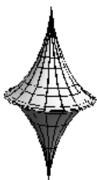
Рис. 3. Поверхности отрицательной кривизны, полученные после исключения части, имеющие разные по знаку кривизны: k_1 = 3, k_2 = 5, k_3 = 7
