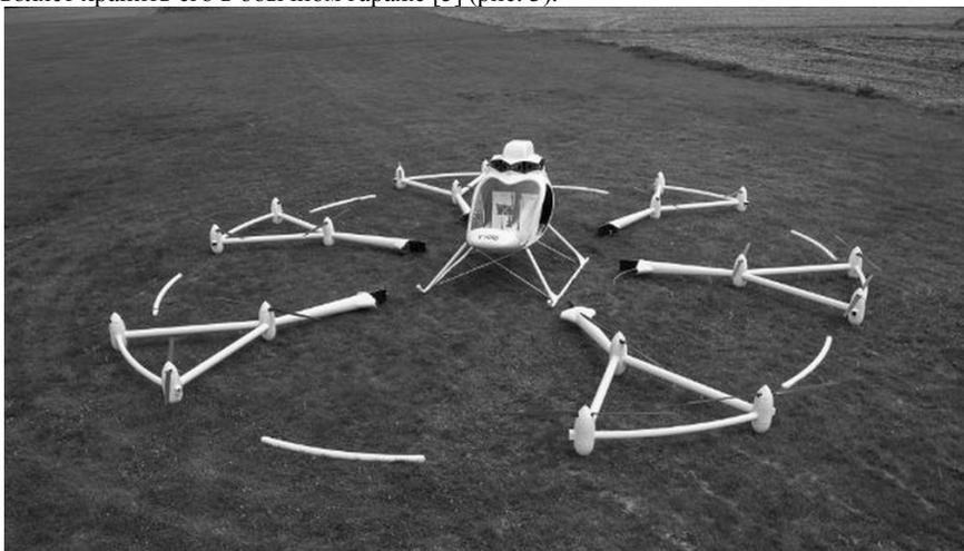
Рис. 3. Разобранные модули Volocopter VC 200
