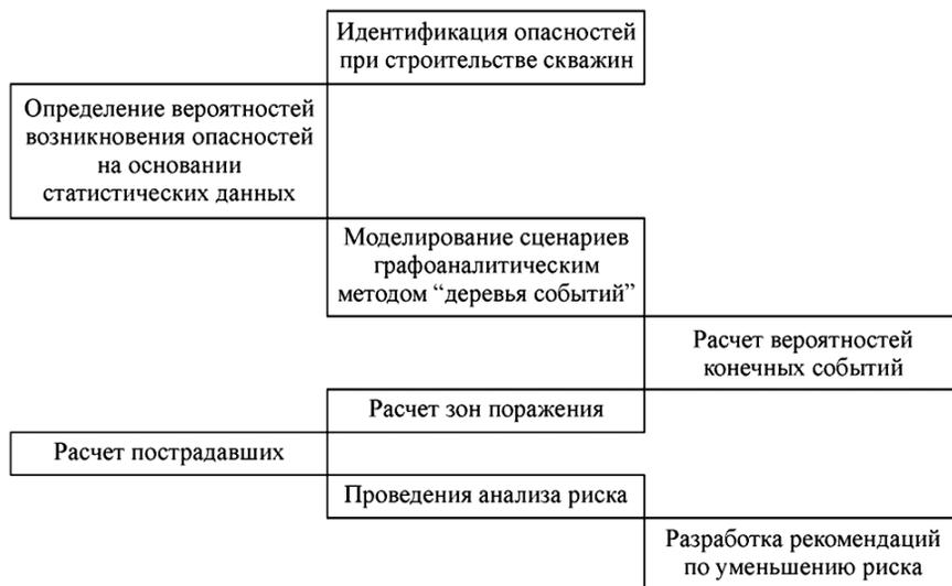
Рис. 1. Блок-схема анализа риска
