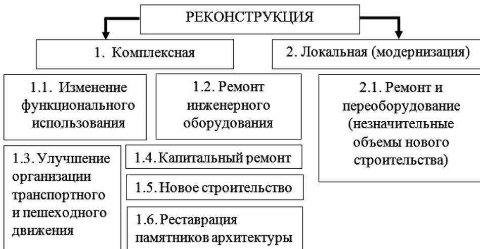
Рис. 1. Основные виды работ при проведении реконструкции
