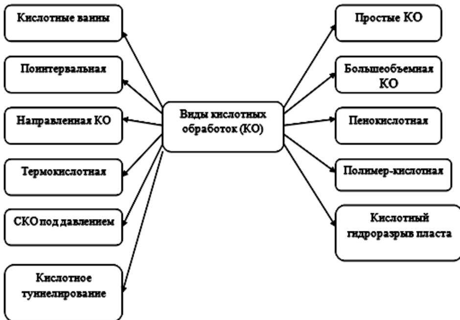
Рис. 2. Классификация методов кислотных обработок карбонатных коллекторов
